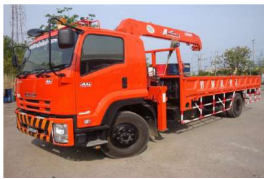
รถบรรทุก ๖ ล้อ ติดตั้งปั้นจั่น
